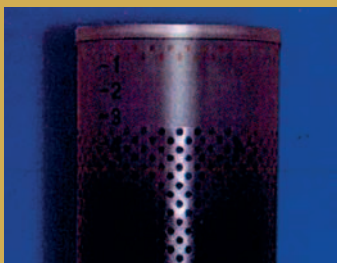
Diesel Kraftstofffilter nach 20.000 km ohne Diesel-PLUS – stark verschmutzte und verstopfte Oberfläche
