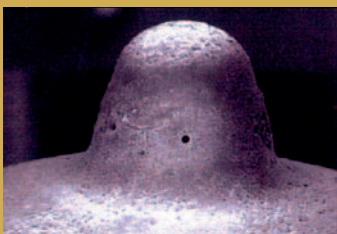
Freie und unverschmutzte Einspritzdüse mit Diesel-PLUS nach Langzeittests
