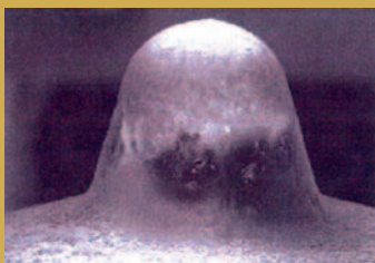
Sichtlich verstopfte Einspritzdüse ohne Diesel-PLUS nach Langzeittests
